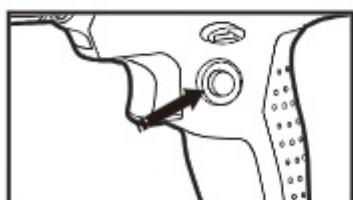
قفل کن کلید سوئیچ: زمانی که نیاز دارید تا دستگاه به صورت پیوسته کار کند، کافی است که پس از فشردن کلید روشن/خاموش و شروع به کار دستگاه، دکمه قفل کن را فشار دهید تا دستگاه بدون نگه داشتن کلید روشن/خاموش در حالت روشن باقی بماند.
